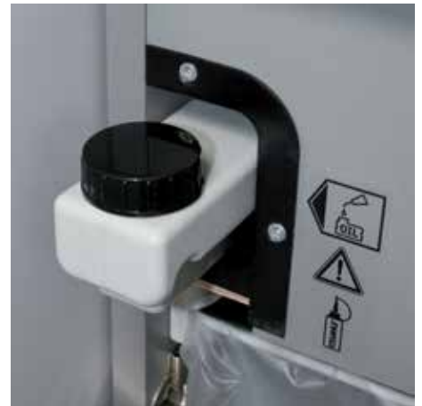
Zintegrowany automatyczny podajnik oleju do automatycznego olejowania cylindrów tnących pomaga wydłużyć ich żywotność
